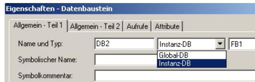
Wie man sieht, ist die Struktur des DB1 (Bild unten) bis auf die temporären Variablen gleich der Variablendeklaration im FB1. Im DB1 können die Variablen außerdem mit einem Anfangswert versehen werden.
