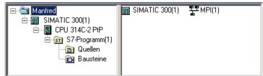
Unter dem Projektnamen „**Manfred**“ wurde vom Assistenten ein Ordner „SIMATIC-Station 300(1)“ eingerichtet. Hinter dem Eintrag „MPI(1)“ verbirgt sich des Tool „**NetPro**“. Dieses Programm ermöglicht die Konfiguration eines MPI-Subnetzes.
